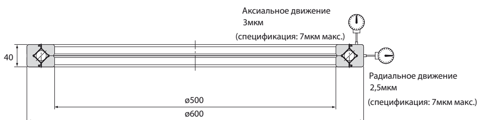
Точность вращения наружного кольца модели RE50040CC0USP
