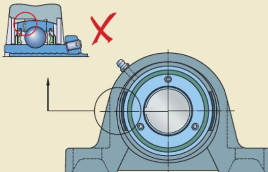
подшипниковых узлов SKF типа Y для производственных линий пищевых продуктов, которые имеют суффикс обозначения L. При монтаже подшипников в такие корпуса фиксирующие устройства должны быть направлены в противоположном направлении к установочным пазам. Убедитесь, что смазочное отверстие или канавка в наружном диаметре подшипника не совпадает с установочными пазами в корпусе, в противном случае может произойти утечка смазки или попадание загрязнений в подшипник (→ рис. 34).
