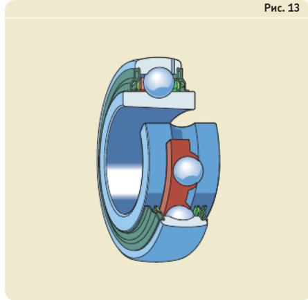
по одному с каждой стороны от дорожки качения, расположенных под углом  $120^\circ$  друг к другу. По индивидуальному заказу могут поставляться подшипники без смазочных отверстий (суффикс W).
