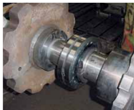
Подшипниковые опоры в приводах конвейеров и подъемно-транспортного оборудования
