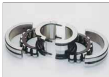
4. Разъемный сферический роликоподшипник с разъемным массивным сепаратором из стеклонаполненного полиамида или из латуни, с интегрированными закрепительными кольцами
