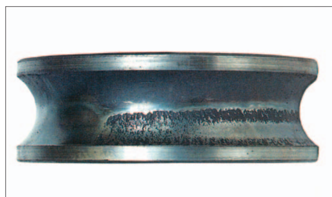
Часть: Внутреннее кольцо контактного радиально-упорного шарикоподшипника Признак: Шелушение происходит диагонально по дорожке качения Причина: Неправильное выравнивание между валом и корпусом во время установки
