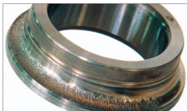
Часть: Внутреннее кольцо контактного радиально-упорного шарикоподшипника Признак: Шелушение происходит вокруг одной второй поверхности окружности дорожки качения Причина: Неправильная смазка из-за попадания СОЖ в подшипник
