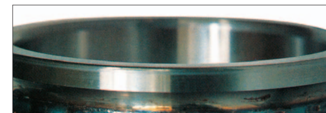
Часть: Внутреннее кольцо радиально-упорного шарикоподшипника Признак: Обесцвечивание дорожки качения; Плавление происходит в интервалах между шариками Причина: Чрезмерная предварительная нагрузка
