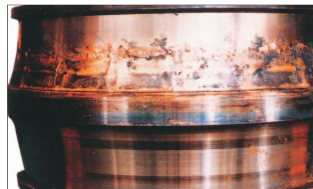
Часть: Внутреннее кольцо сферического роликоподшипника Признак: Обесцвечивание и плавление дорожки качения; изношенные частицы сепаратора вращались и пристали к дорожке качения Причина: Недостаточная смазка
