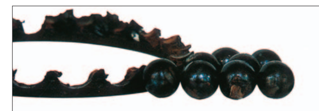
Часть: Шарикоподшипник радиально-упорного шарикоподшипника Признак: Сепаратор поврежден плавлением; шарикоподшипник обесцвечен и оплавлен Причина: Чрезмерная предварительная нагрузка
