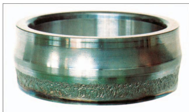
Часть: Внутреннее кольцо сферического роликоподшипника Признак: Шелушение одной дорожки качения по всей окружности Причина: Чрезмерная осевая нагрузка
