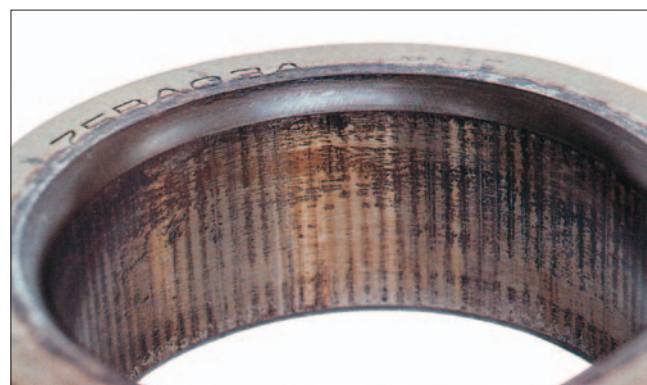
Часть: Внутреннее кольцо радиально-упорного шарикоподшипника Признак: Заметное коррозийное истирание происходит по всей окружности поверхности отверстия Причина: Недостаточная посадка с натягом
