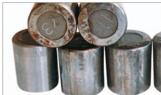
Часть: Конические ролики конического роликоподшипника в два ряда Признак: Многоярусный износ на торце ролика Причина: Прогрессия коррозионного истирания из-за чрезмерной нагрузки в состоянии покоя
