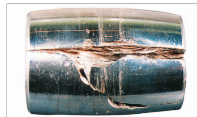
Часть: Ролик сферического роликоподшипника Признак: Осевые трещины на поверхности ролика
