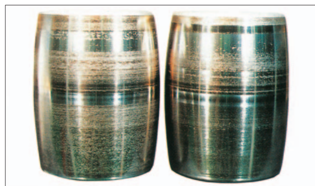
Часть: Выпуклые ролики сферического роликоподшипника Признак: Размывание происходит в центре поверхности качения Причина: Неправильная смазка
