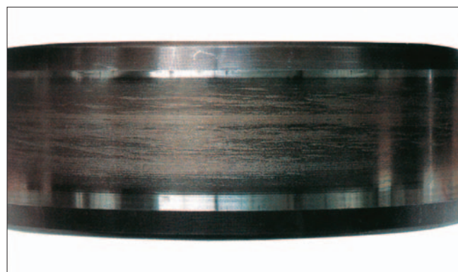
Часть: Внутреннее кольцо цилиндрического роликоподшипника Признак: Размывание происходит по окружности поверхности дорожки качения Причина: Проскальзывание ролика из-за чрезмерной смазки
