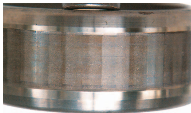
Часть: Внутреннее кольцо цилиндрического роликоподшипника Признак: Множество впадин из-за электрической коррозии; волнообразный износ поверхности дорожки качения Причина: Электрическая коррозия
