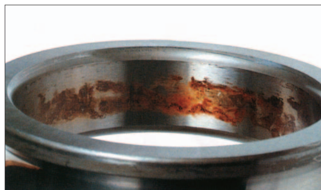
Часть: Внутреннее кольцо радиального шарикоподшипника Признак: Коррозийное истирание происходит на поверхности отверстия Причина: Вибрация
