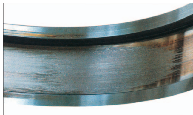
Часть: Внешнее кольцо цилиндрического роликоподшипника Признак: Размывание происходит по окружности поверхности дорожки качения Причина: Проскальзывание ролика из-за чрезмерной смазки
