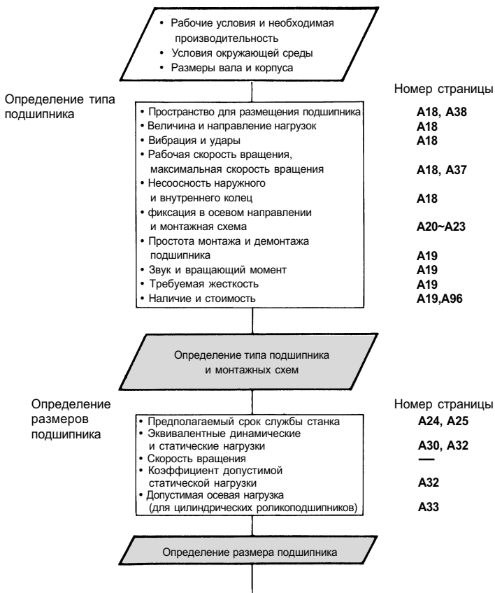
Рисунок 2.1. Схема подбора подшипников качения
