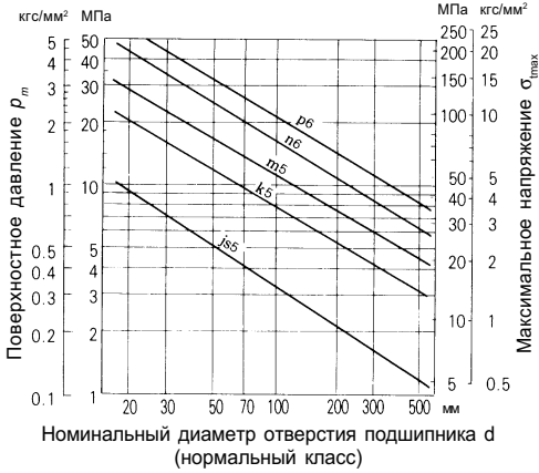
Рис. 15.5 Поверхностное давление p_m , а также максимальное напряжение \sigma_{max} для среднего натяга
