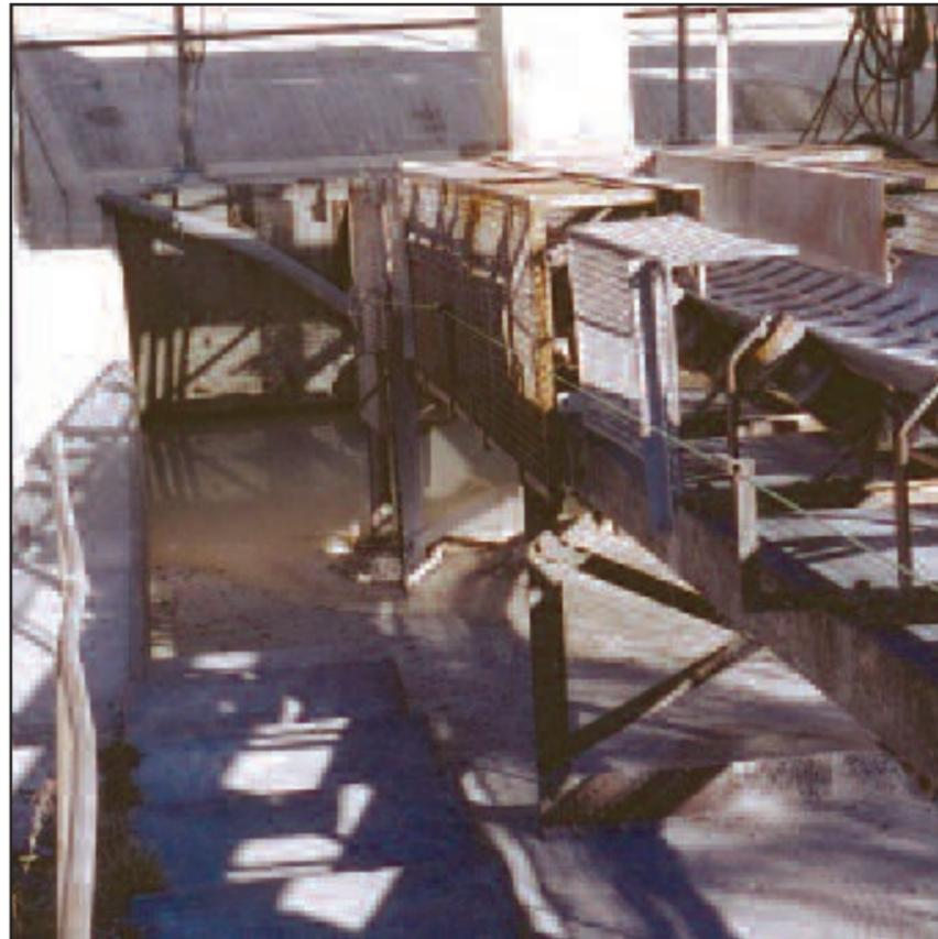
Вода, скопленная в хвостовом барабане и попавшая на подшипники. В результате, подшипник SNL 515 - 612 на валу 100мм выходил из строя каждые 2 - 3 месяца.
