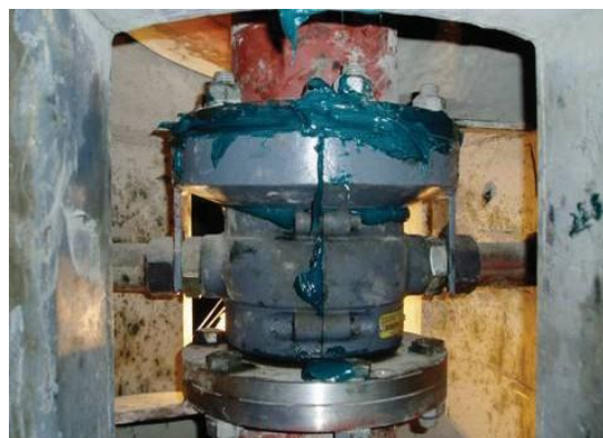
Чугунный подвесной узел с двойным приливом на вертикальном вале
