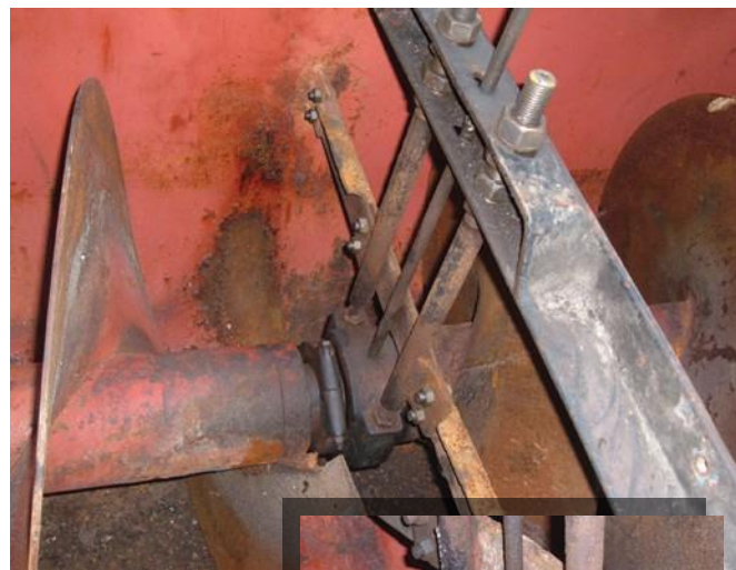
Винтовой конвейер, оборудованный ненадёжным подшипником скольжения, до переоборудования
